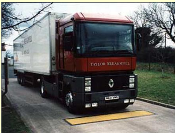
Figura 23 - Cântar fix prevăzut cu o placă metalică peste care trec vehiculele pentru cântărire; Cisterna A 59 (sursă DRDP – Timișoara)
