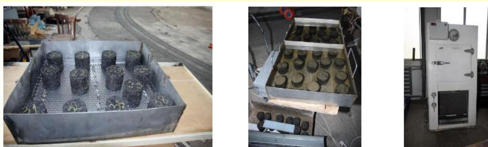
Fig. 14 – Epruvete cilindrice pregătite pentru congelare
