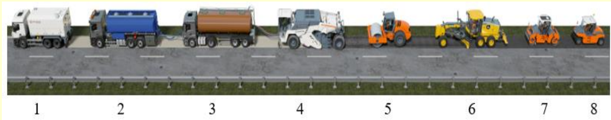
Fig. 18 – Tren reciclare pentru bitum spumat sau emulsie bituminoasă
