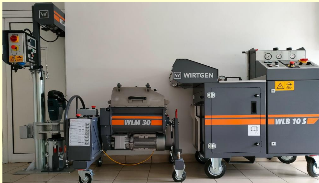
Fig. 13 - Echipament WIRTGEN pentru amestecuri reciclate la rece (2022)
